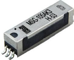
この製品は、弊社MSGシリーズに高温動作保証を付したリレーです。弊社高温動作製品のMGシリーズと比べ、切断電流/電圧と通電に優れており、有負荷検査に適しています。使用動作保証温度 (-20℃ ~ +155℃) は、高温環境試験規格に準じており多様なニーズに対応可能です。DRAM(KGD検査)、Flash Memoryの高温試験やIG-BTの高温通電環境試験などに使用されています。
